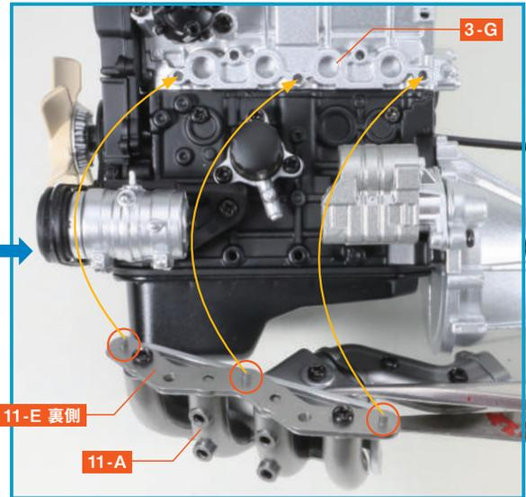
備妥已經組裝到第10期的引擎，將 11-E 背面的三個較粗的突起部分插入汽缸頭 3-G 的孔中，對齊螺絲孔。
