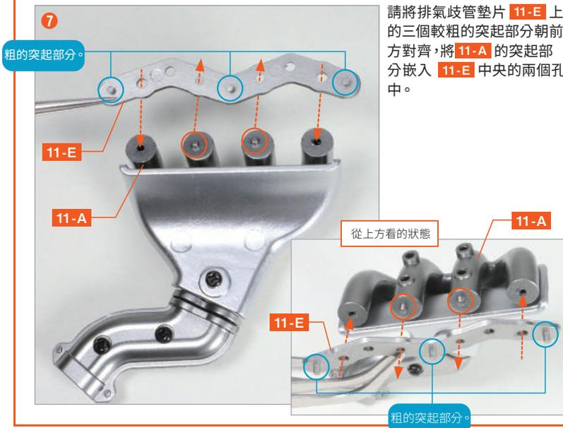
請將排氣歧管墊片 11-E 上的三個較粗的突起部分朝前方對齊，將 11-A 的突起部分嵌入 11-E 中央的兩個孔中。
