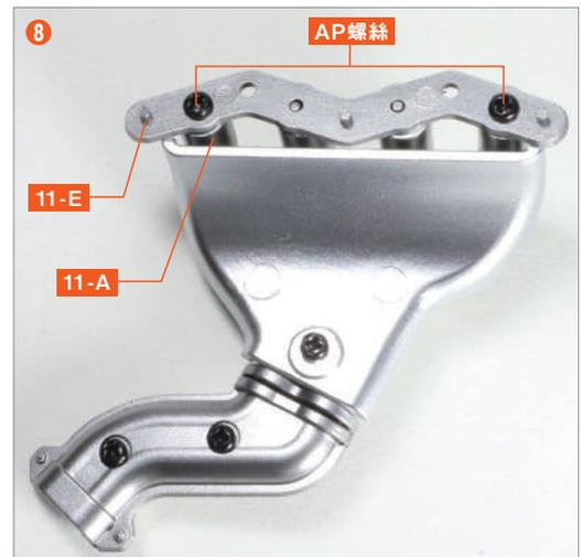
對準 11-E 和 11-A 的螺絲孔，使用 AP 螺絲 在兩個位置固定。
