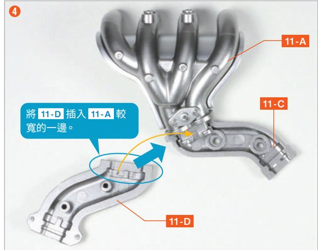
接著，將排氣前管上部 (2) 11-D 覆蓋上。將 11-A 的底部，夾在 11-C 和 11-D 的溝槽中組裝。
